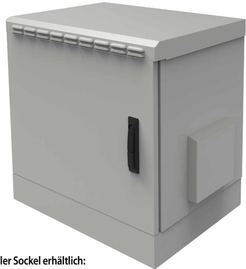
Die links- und rechtsseitigen Lufteinlässe mit Filtern (IP54) sind zusätzlich durch äußere Metallhauben geschützt. Dies ermöglicht die Frischluftzufuhr sowie Evakuierung der Abluft durch die Lamellen im Dach.
